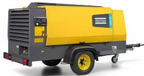
Компрессор крепится к любому грузовому автомобилю при помощи прицепного соединения, которое регулируется по высоте. Через патрубок диаметром 2" сжатый воздух поступает к потребителю. При помощи специальных механизмов, осуществляется оптимальное соотношение потребленного сжатого воздуха к выработанному. Цифровой двухстрочный дисплей, на котором отображается вся необходимая информация. Большое количество дополнительных опций.
