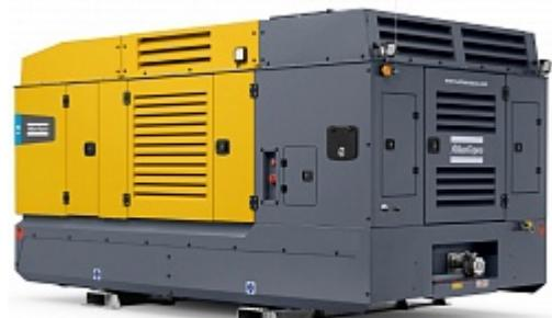
Для буксировки за транспортным средством, компрессор может быть установлен на шасси с выдачей ПСМ, возможно исполнение без шасси для стационарного использования.
