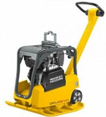
DPU 2540 Н -компактная реверсивная виброплита с дизельным двигателем HATZ. Узкое основание позволяет эффективно уплотнять грунт в траншеях. Разработана для интенсивной эксплуатации с выдерживанием нагрузок промышленного уровня. Подходит для трамбовки связных и несвязных грунтов. Общая масса плиты 160 кг в сочетании с эксцентрикром 25 кН гарантируют превосходное уплотнение.
