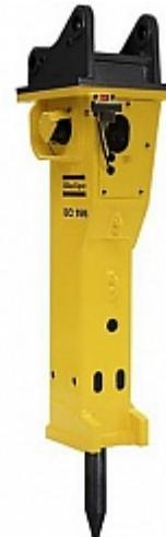
EC 155 T использует моноблочную конструкцию, которая объединяет нижнюю часть молота и цилиндр в единый блок, а также внутренний управляющий клапан, который обладает высокой скоростью переключения и пропускной способностью из-за отсутствия дополнительных деталей и гидравлических разъемов.
