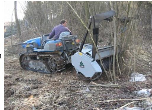
Низкорасположенный вал отбора мощности позволяет кардану работать при оптимальном угле, а корпус усилен для осевых нагрузок при повороте гусеничного трактора. Это позволяет избежать повреждений корпуса и некоторых компонентов, например, подшипников и втулок ротора.
